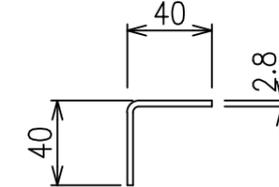
端柱断面図 S=1/3
